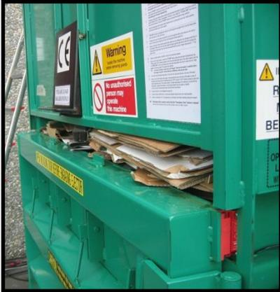
Le matériau doit être repoussé à la main dans la chambre de pressage !
