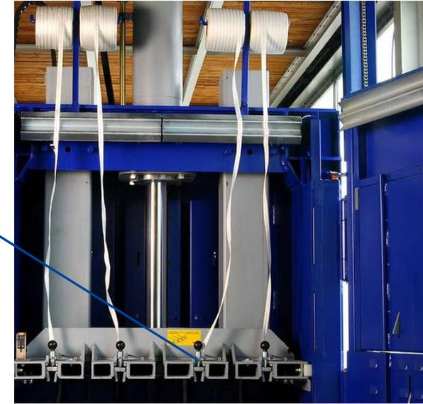
Lors de l'insertion de la bobine, la bobine est enfilée à travers l'œillet. La bobine de la balle est récupéré depuis la paroi arrière vers l'ouverture à l'avant avec des crochets de tirage intégrés. Le panneau de passage sert de guide.
