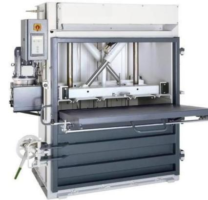
La variante avec un agencement en X de deux cylindres presseurs se traduit par des pertes de forces importantes en raison de la position angulaire. Seule une petite partie de la force du cylindre est utilisée pour la force de pressage. Pour obtenir les mêmes forces de pressage que Strautmann, la puissance hydraulique doit être augmentée.
