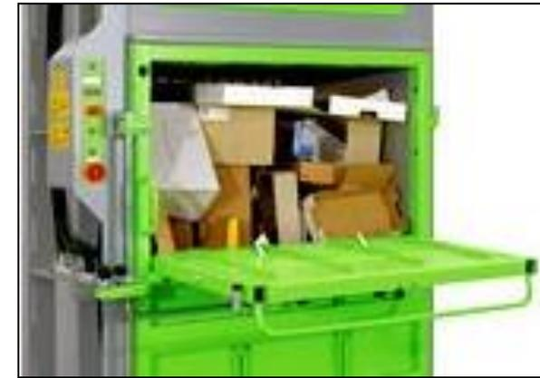
La trappe ouverte provoque la distance pendant de l'insertion !
