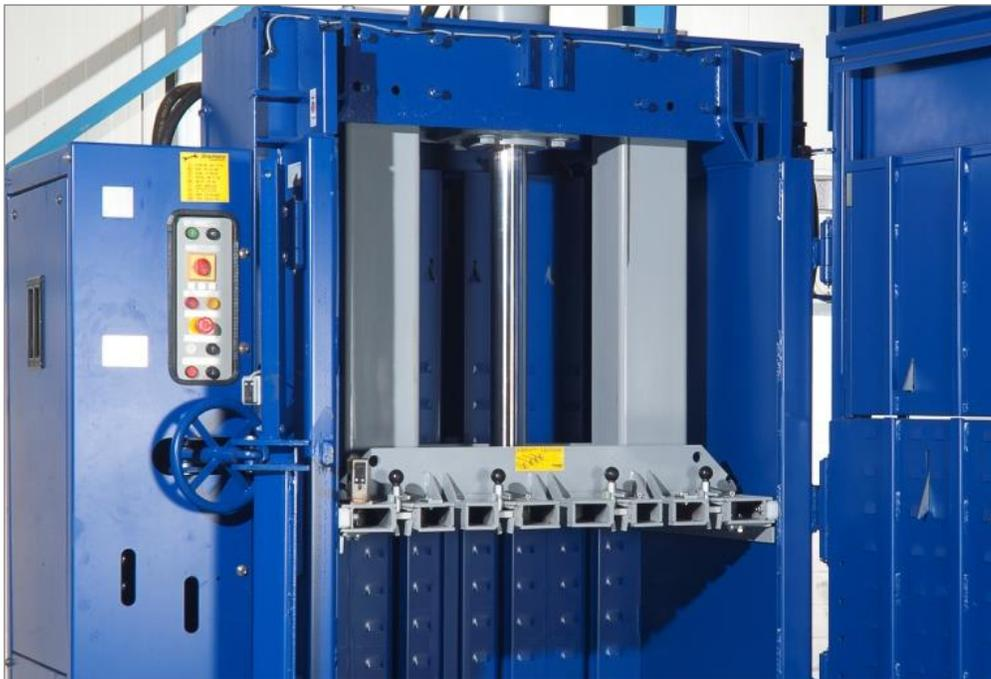
Deux tubes de guidage très stables améliorent l'absorption de la force du panneau de pressage sous une charge unilatérale, qui apparaît, par exemple, en raison d'un remplissage non uniforme de la chambre de pressage. Cela permet ainsi de soulager d'autres composants importants.
