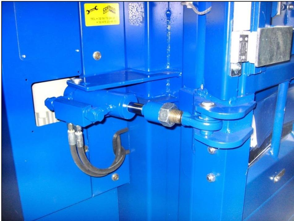
La serrure de porte hydraulique contrôle les importantes forces de ré-expansion des grosses balles de films.
