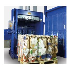
Éjection hydraulique des balles L'éjection hydraulique des balles garantit une éjection sûre et simple..
